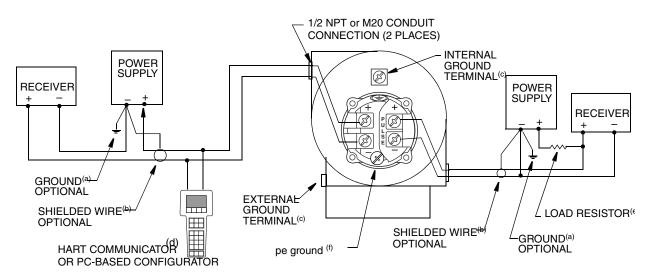
(a) GROUNDING THE LOOP AT THE NEGATIVE TERMINAL OF THE POWER SUPPLY IS RECOMMENDED BUT NOT REQUIRED.
